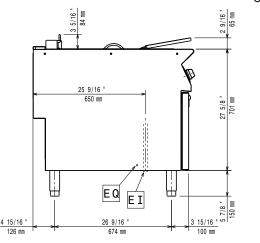
Electrical inlet (power) ΕI Equipotential screw EQ
